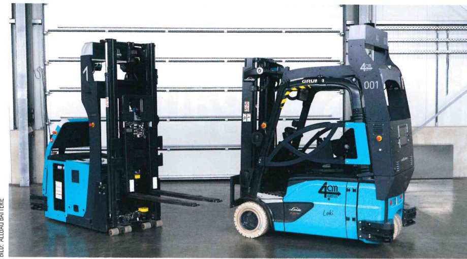
Autonom fahrende Gabelstapler, ausgestattet mit Lithium-Ionen-Batterien von Allgäu Batterie
